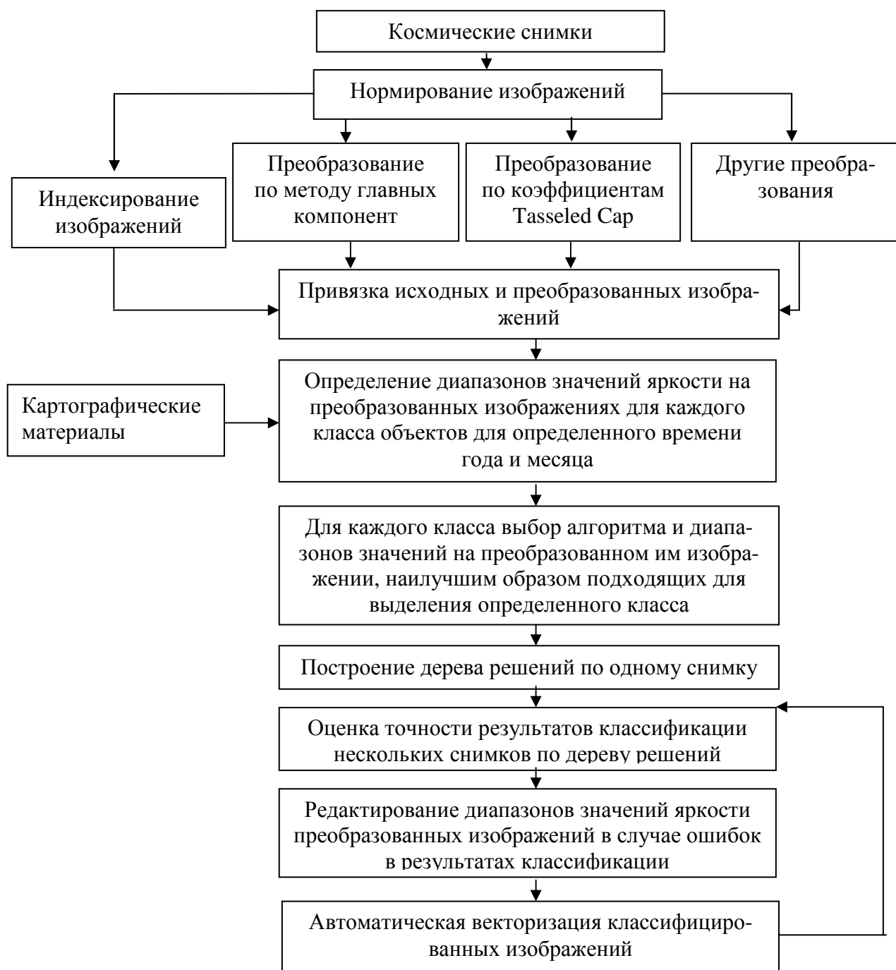
Рисунок 2 – Технологическая схема методики автоматизированного дешифрирования снимков с помощью алгоритма «Дерево решений»
