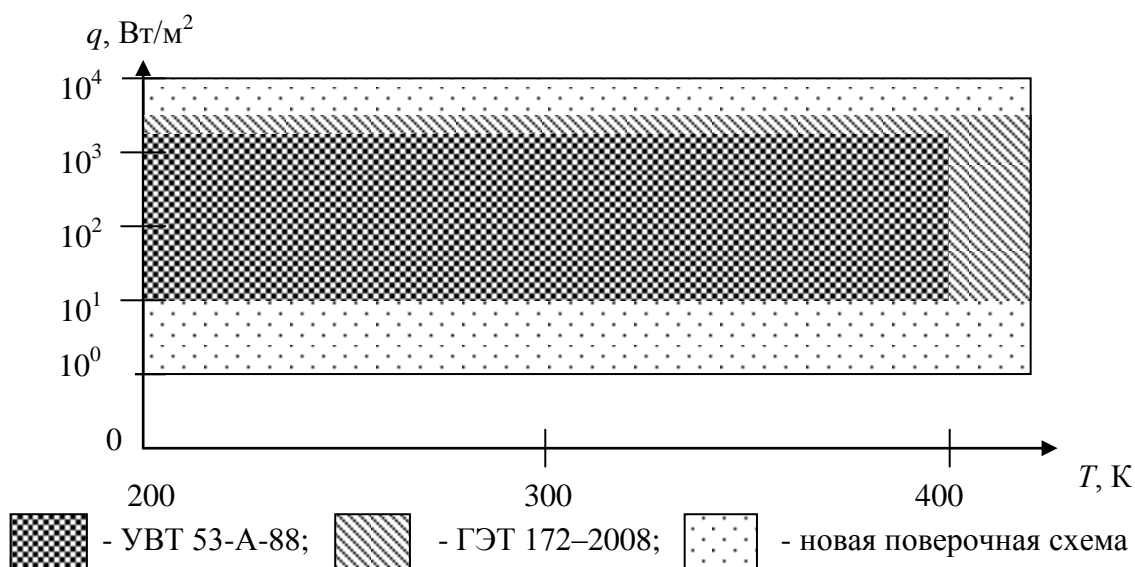
Рисунок 2 – Диапазоны значений плотности теплового потока и температуры, воспроизводимые и передаваемые УВТ 53-А-88 (МИ 1855-88), ГЭТ 172-2008 и новой поверочной схемой
