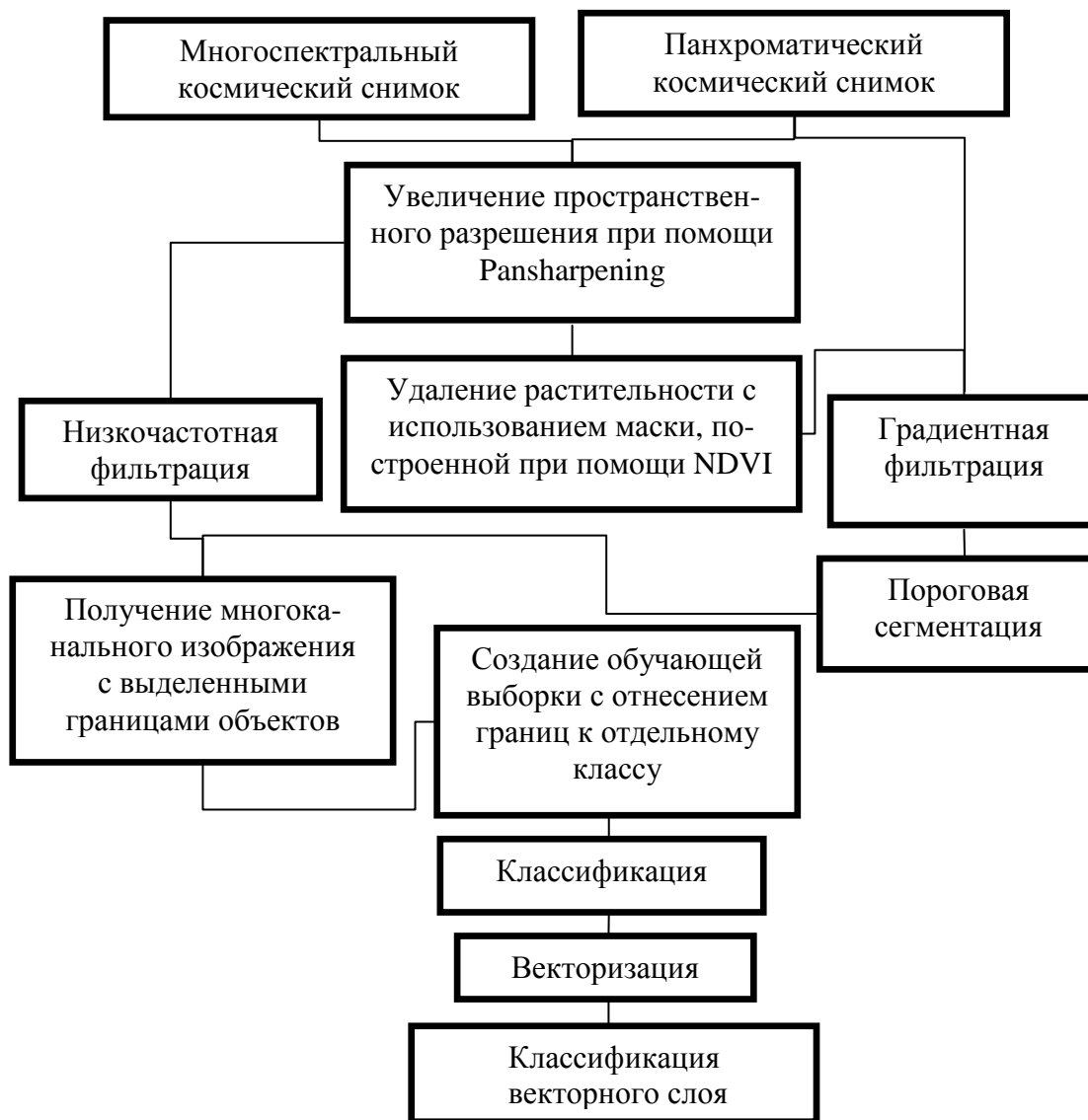
Рисунок 2 – Технологическая схема методики автоматизированной классификации с использованием градиентных фильтров
